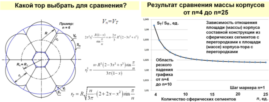
Рисунок 1 – Сравнение двух корпусов с общей центральной осевой окружностью
