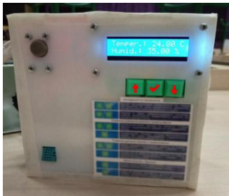
Рисунок 2 – Модуль управления и компоненты слева направо: сверху – датчик углекислого и угарного газов MQ-135, ЖК дисплей, три кнопки управления; снизу – датчик температуры/влажности DHT-11, руководство по эксплуатации
