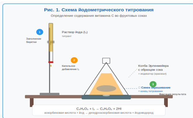
Рисунок 1 – Схема йодометрического титрования аскорбиновой кислоты
