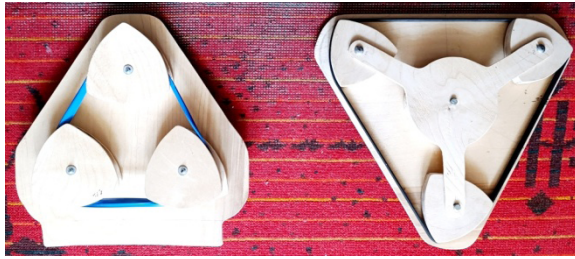
Рисунок 3 – Действующие макеты новой ременной передачи
