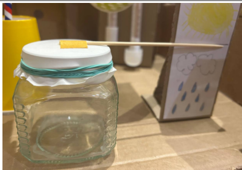
Рисунок 2 – Барометр из стеклянной банки и воздушного шарика
