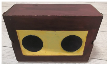
Рисунок 1 – Прототип радиоприемника с функцией отслеживания психофизиологического состояния здоровья пожилого человека
