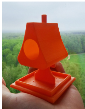
Рисунок 9 – Образец из PLA-пластика кормушки №1/1 комплекса ЭКО-домик «Гриб для крылатых гостей»
